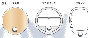
でイヤのグラングペイトを、ウエイトの位置でカットした断面図のイメージ。バルサには塗装やコーティングの被膜がボディ外側に壁となって存在する。プラスチックはボディ 壁面が肉厚であるばかりか、内部には重心移動のレールや、ウエイトが左右に動かないための壁などが設置されているため、必然的に重くなる。ブリッツはスーパーハニカムドサボディによって肉厚を薄くすることができただけでなく、浮力の向上と軽量化を両立。また、メインウエイトを極限まで下げたことできたができた。大変インウエイトを極限まで下げたことでとでハイビッチなローリングアグションを見せる
